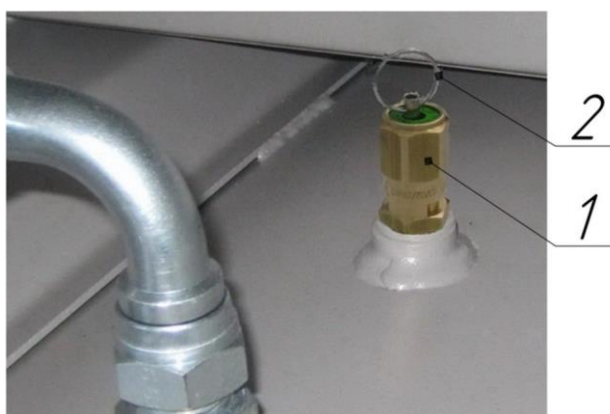
Рисунок 10 – Клапан предохранительный пружинного типа
