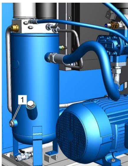
Рис. 32: Проверка уровня охлаждающей жидкости через смотровое отверстие
